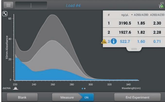
Vea varias muestras a la vez en la pantalla de medición. Aquí Acclaro™ ha marcado dsDNA la muestra # 3 de dsDNA al detectar la presencia de un contaminante .
