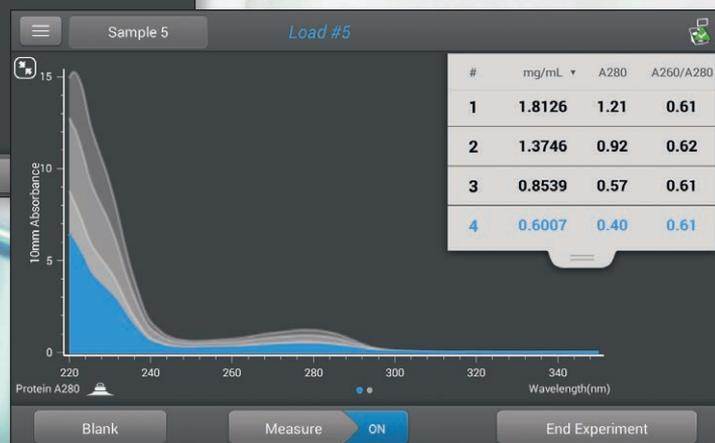
Cuatro diferentes muestras de proteínas purificadas se midieron utilizando la aplicación A280 proteína.
