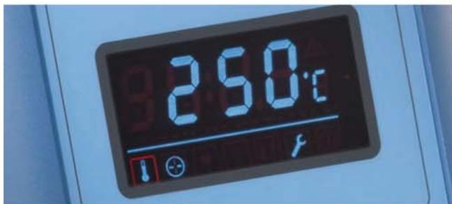
Pantalla fluorescente de vacío, fácil lectura con sencillo control mediante botones táctiles
