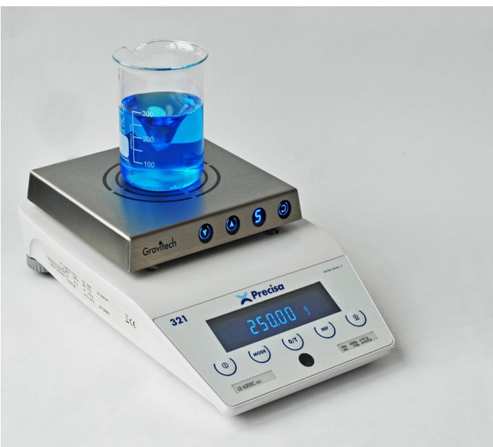
La nueva Balanza-Agitadora combina la versatilidad de pesaje y agitación de forma simultánea. La Balanza-Agitadora mide con 10 mg de legibilidad hasta un peso máximo de 6.200 g (según el modelo), posible gracias al nuevo modelo desarrollado de agitador magnético que está integrado en el platillo. Este combinación asegura un impecable cumplimiento sin igual con la precisión en todo el rango de pesaje.
